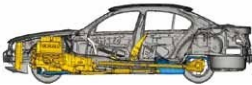
懸架系統的輪軸最上部撞上防護欄的碰撞分析結果
